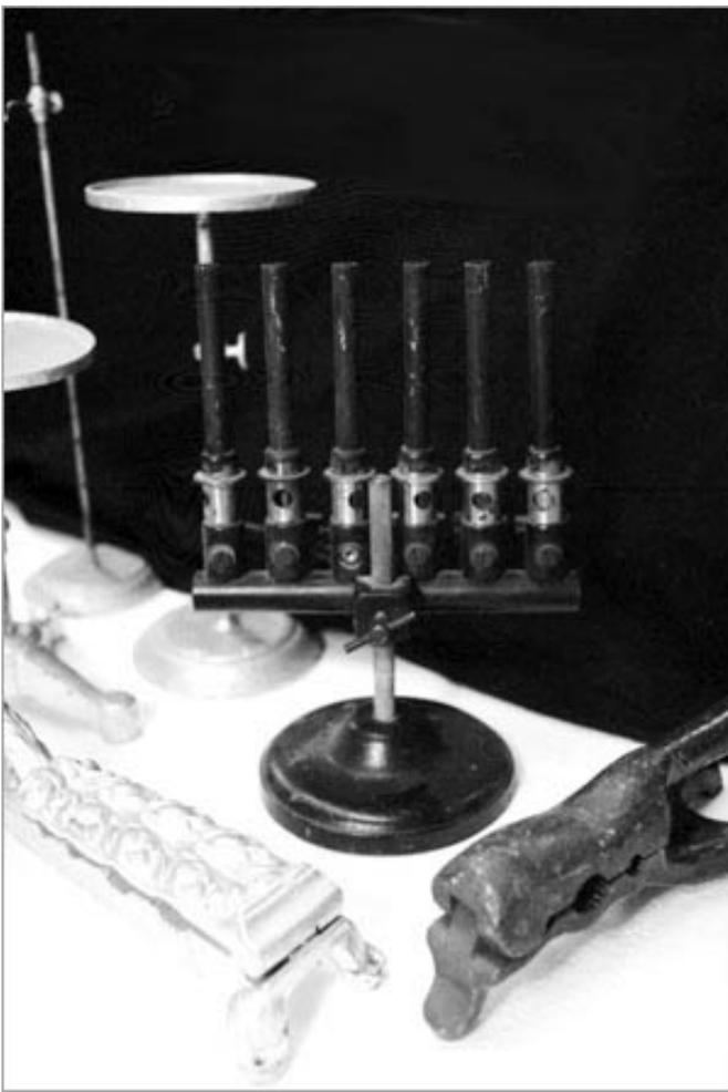
Reihenbrenner zum gleichmäßigen Erhitzen von Röhren; außerdem Korkpressen, zum Verschließen von Flaschen (Chemie).
