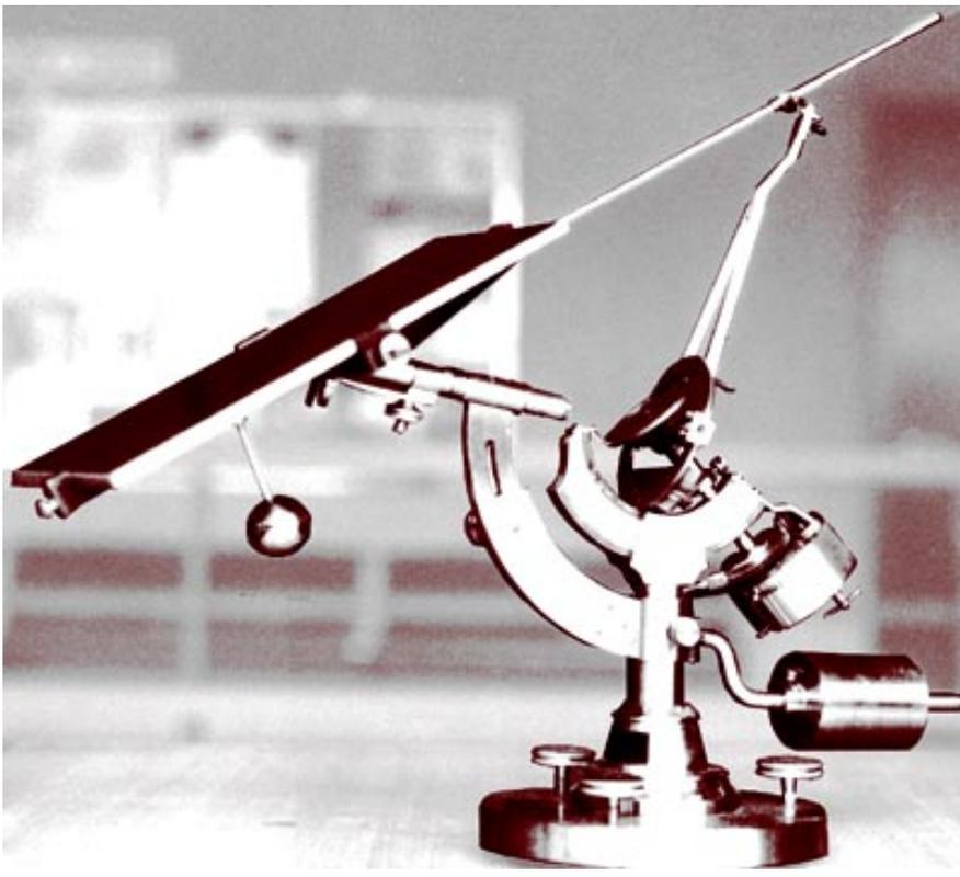
Universal-Heliostat (mit Uhrwerk) von 1888. Mit diesem Gerät kann das Sonnenlicht gebündelt werden, etwa zur Beleuchtung von Mikroskopen - ausgestellt im Physikalischen Institut der Universität Tübingen.
