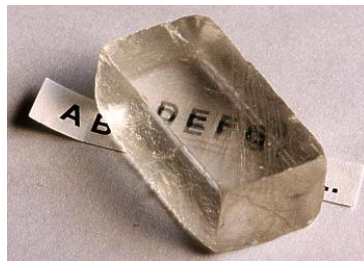
Abb. 2.18: Doppelbrechung beim Calcit.
