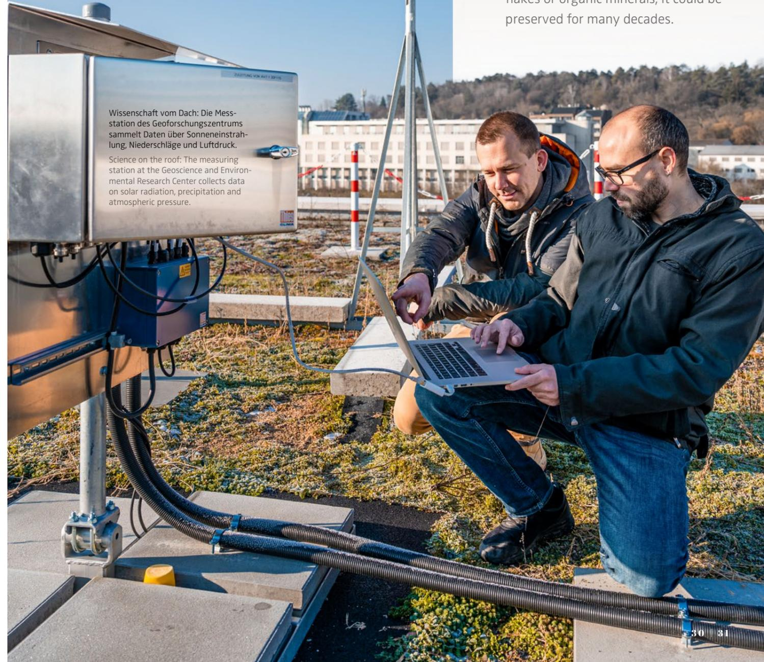
Wissenschaft vom Dach: Die Messstation des Geoforschungszentrums sammelt Daten über Sonneneinstrahlung, Niederschläge und Luftdruck.
