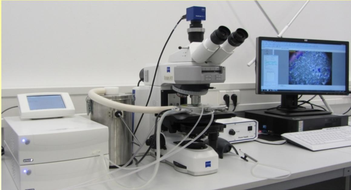
*Heiz-Kühltisch* (heating-freezing stage) in Kombination mit Mikroskop
