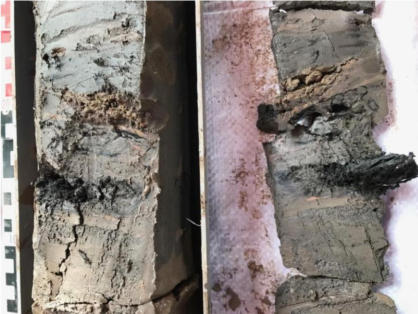
Sediment einer Grundwasserbohrung aus VanPhuc, Hanoi, Vietnam: Das dunkle organische Material stammt zum Beispiel aus altem abgestorbenen Material ehemaliger Mangrovenwälder, das in den Sedimenten erhalten wurde. Dieses organische Material wird von Bakterien als Energie- und Nahrungsquelle genutzt, wodurch Arsen enthaltende Eisenminerale aufgelöst werden. Foto: Andreas Kappler.
