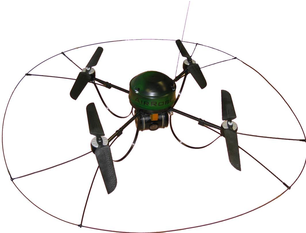
**Abbildung 2.1:** Der verwendete Quadrokoopter *AR100* (Firma *AirRobot*, Amsberg, Deutschland). Unterhalb des zentralen Körpers sitzt die Rotationstrommel mit der Kamera.
