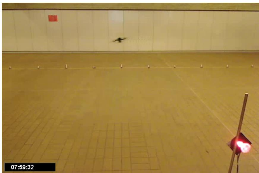
**Abbildung 7.1:** Meßaufbau aus Sicht der verwendeten Kamera. Der Roboter fliegt oberhalb der weißen Meßlinie, auf der im Abstand von einem Meter Positionsmarken angebracht sind, von rechts nach links. Rechts im Vordergrund befindet sich die Leuchtdiode, die signalisiert, daß eine auszuwertende Messung gerade aufgezeichnet wird. Links unten im Bild ist der zugehörige Zeitstempel eingeblendet.
