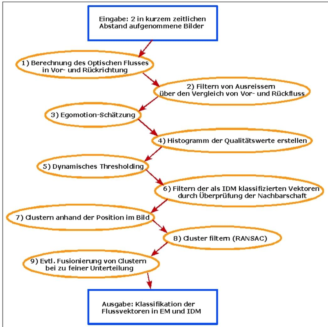
Abbildung 3.3: Das Flussdiagramm des implementierten Algorithmus
