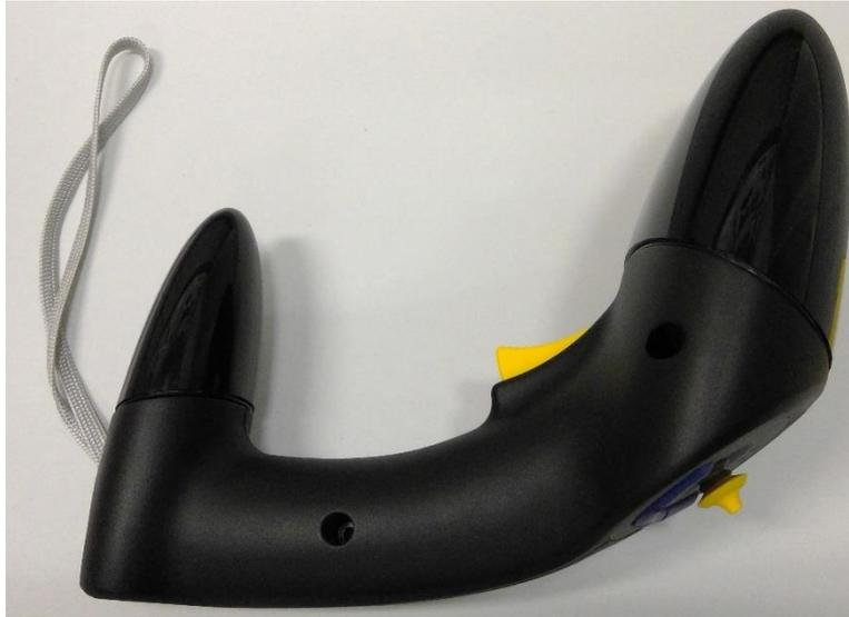
Abbildung 3: Virtual-Reality-Controller Flystick 2 von A.R.T. GmbH, Weilheim.
