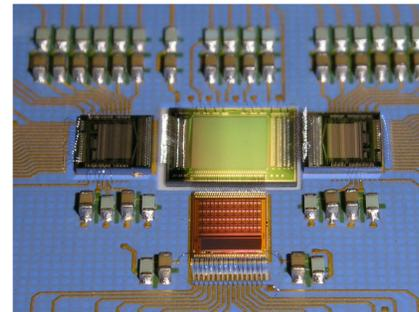
In der Mitte ist eine Matrix aus  $64 \times 64$  *DEPFET*s zu erkennen. Links und rechts befinden sich Chips, welche die einzelnen Zeilen selektieren. Im Vordergrund sitzt der *CAMEX*, der die Signale der 64 Spalten parallel verstärken kann.
