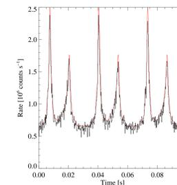
Simulierte Lichtkurve des Crab-Pulsars. Die Abweichung zwischen der Eingangslichtkurve (rot) und der Ausgangslichtkurve (schwarz) liegt an der Totzeit des Detektors (hier  $20 \times 40$  Pixel-Matrix).
