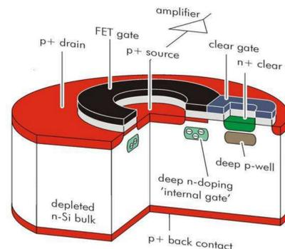
Schematische Zeichnung eines einzelnen *DEPFET* Pixels. In der Mitte befindet sich das *Interne Gate*, in dem sich die Elektronen sammeln. Der Clear-Kontakt dient zum Entfernen der Elektronen aus dem Internen Gate.
