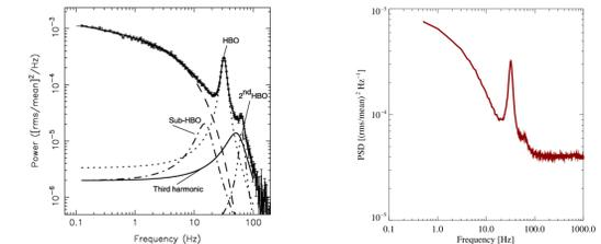
**Links:** Powerspektrum des Röntgendoppelsterns GX 5-1, erkennbar sind quasiperiodische Oszillationen (584000s Beobachtung mit RXTE) **Rechts:** Simuliertes **XEUS** Powerspektrum mit 6000s Belichtungszeit.
