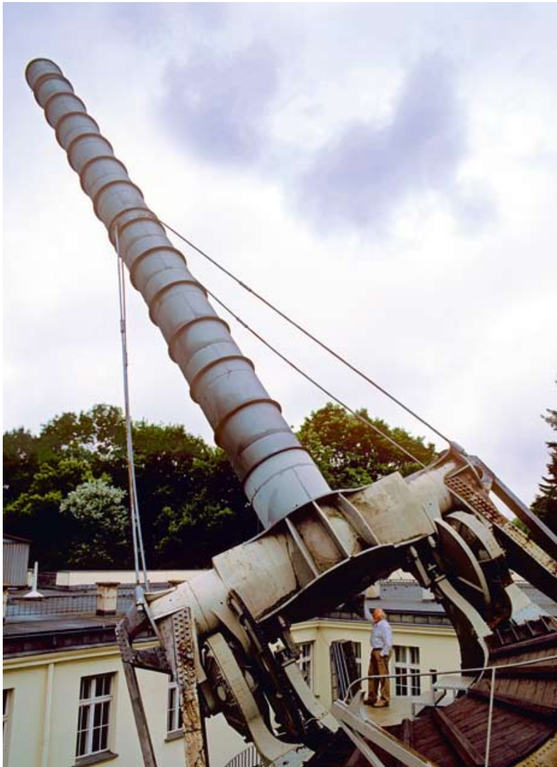
Mit 21 Meter Brennweite immer noch der längste Refraktor der Welt: das »Kanonenrohr« der Archenhold-Sternwarte in Berlin-Treptow.
