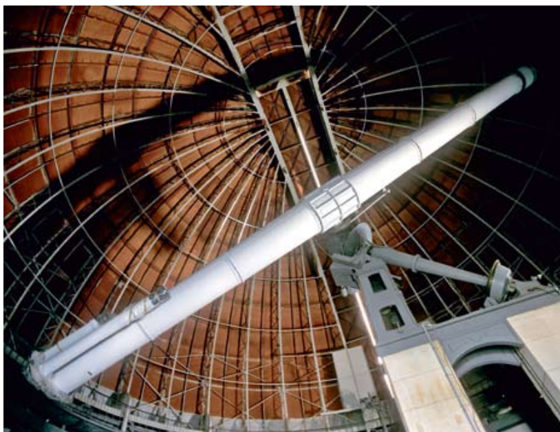
Ein schlanker Riese: der 76,9-Zentimeter-Refraktor der Sternwarte Nizza mit 17,9 Meter Brennweite. Die Optik stammt von den Brüdern Henry.
