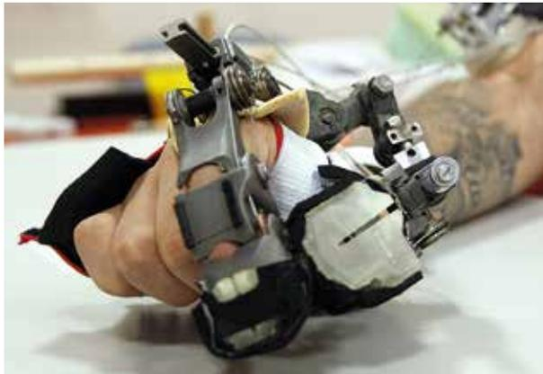
*Hirngesteuertes Hand-Exoskelett: Solche Systeme sollen in dem Projekt KONSENS-NHE weiterentwickelt werden.*
