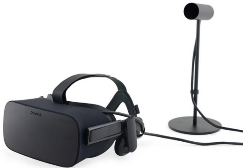
*Abbildung 3: Auf dem Bild sind das HMD Oculus Rift und der Positionstracker, der die Infrarot-Dioden der Oculus Rift erfasst, dargestellt. Mit Hilfe des Positionstrackers ist es möglich die Position der VR-Brille im Raum zu ermitteln und dadurch diese Position auf in der virtuellen Umgebung zu aktualisieren.*
