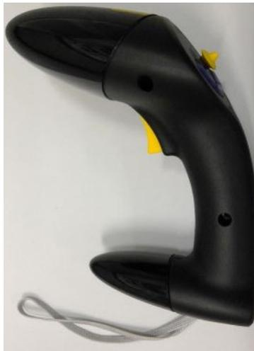
*Abbildung 2: VR-Controller Flystick 2 mit dem die Zeigebewegungen der Versuchspersonen während der Abfragephase aufgezeichnet wurden. Zu erkennen ist an der Vorderseite die gelbe Trigger-Taste, mit der die Zeigebewegung bestätigt wurde.*
