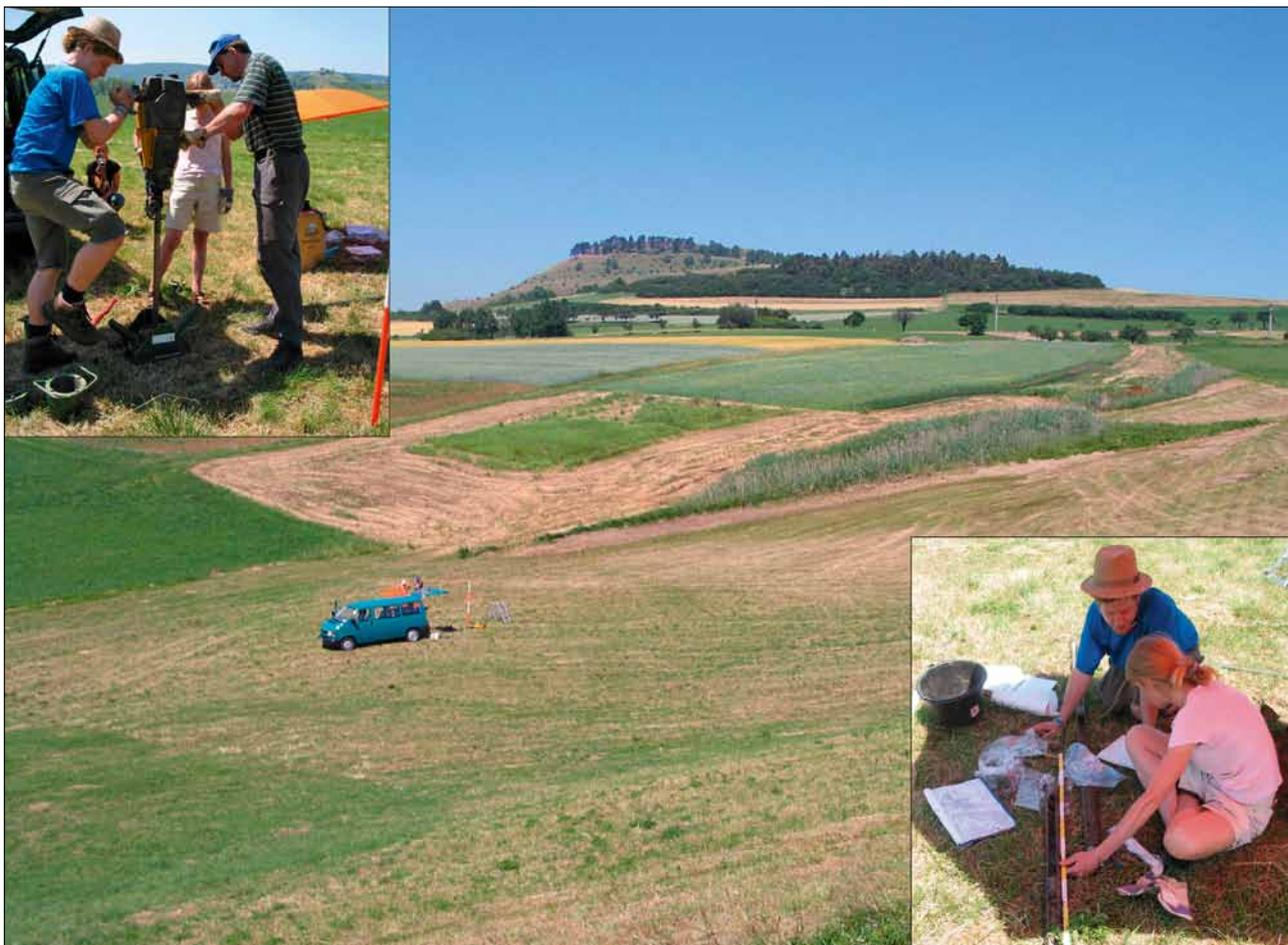
**Abb. 3** Zur Überprüfung von Sedimentaufbau und -mächtigkeit wurden Rammkernsondierungen mit einem COBRA-Motor-Bohrhammer durchgeführt. An dieser Stelle in der Tiefenlinie des Grundbachtals, unterhalb des frühkeltischen Rechteckhofs am Oberhang, konnte nachfolgend ein Baggerschurf (BS3) angelegt werden (vgl. Abb. 2,3).
