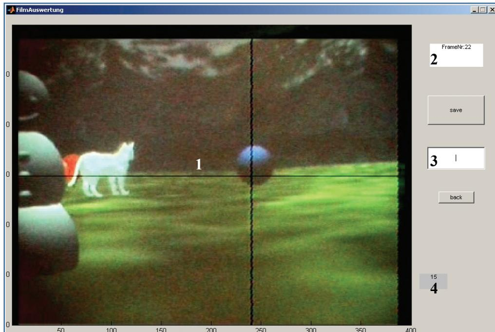
**Abb. 52: Anzeige- und Eingabefenster des manuellen Auswertungsprogramms:** Links wurden Einzelbilder des digitalisierten Videofilms gezeigt (1). Rechts oben wurde die aktuelle Framenummer angezeigt (2). In das Eingabefeld (3) wurde die Nummer des Objekts eingegeben, auf dem das Fadenkreuz zu diesem Zeitpunkt lag. Unten rechts wurde zur Kontrolle die zuletzt eingegebene Nummer angezeigt (4).
