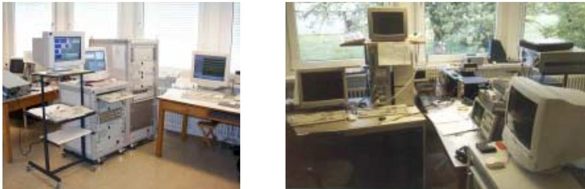
**Abbildung 5.5:** Das Entwicklungslabor in Tübingen. **Links:** Im frühen Stadium der Entwicklung stand noch keine DPE zur Verfügung. Diese wurde durch Simulatoren ersetzt. Die beiden Schaltschränke in der Mitte simulieren den Satelliten nach der HEPI. **Rechts:** Typische Arbeitsumgebung zum Test der HEPI. Von Links: PC mit Detektorsimulator (Hard- und Software), PC zum Brennen und Löschen der EEPROMs, die Platinen der HEPI im Testrahmen, die DPE, Logicanalyser, CDMU Simulator.
