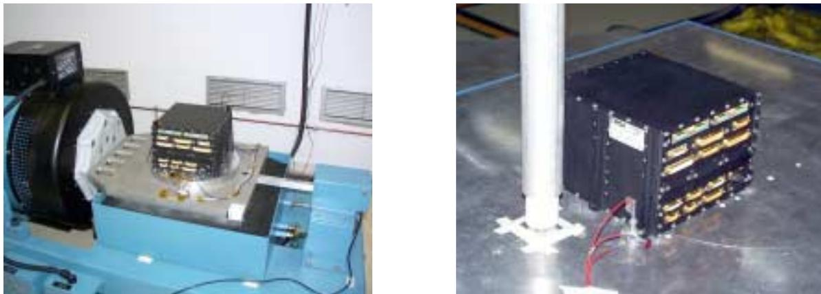
**Abbildung 5.3:** Die Schock- und Vibrationstests der DPE mit der HEPI wurden in Madrid durchgeführt. **Links:** Die Apparatur zur Erzeugung der Vibrationen ist im Prinzip ein riesiger Lautsprecher. Hier wurde die DPE mit bis zu 20 g geschüttelt. **Rechts:** Durch einen definierten Schlag auf die Montagefläche der DPE wird die Elektronik bis zu 1500 g ausgesetzt.
