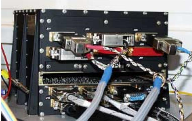
**Abbildung 2.16:** Die DPE während der Entwicklung und Tests an unserem Institut. Sichtbar wird der modulare Aufbau der DPE durch Elektronik-Einschübe wie z. B. die HEPI-Platinen. Der dritte Einschub von unten ist leer. Hier wurde gerade die Platine mit den EEPROMs für die DPE entfernt.
