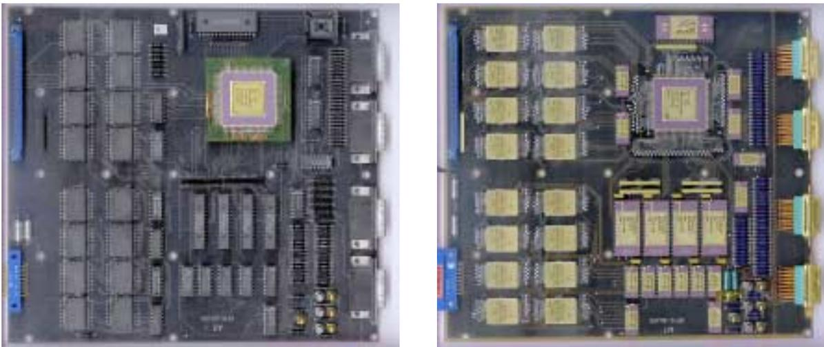
**Abbildung 5.4:** EM und FM der HEPI. **Links:** EM Platine der HEPI. Über eine Adapterplatine ist ein EM des HEPI ASIC eingesetzt. Dadurch kann der ASIC getestet werden. Die leere Fassung rechts über dem ASIC enthält normalerweise das EEPROM für den FPGA. **Rechts:** Eine FM Platine der HEPI. Alle Bauteile sind durch qualifizierte Typen ersetzt worden.
