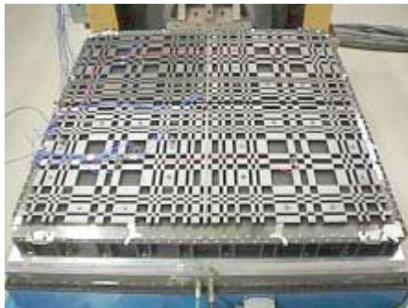
**Abbildung 2.7:** Die kodierte Aperturmaske von IBIS. Deutlich ist entgegen der Schemazeichnungen die makroskopische Dicke der einzelnen Elemente zu erkennen. Nur so kann bei diesen Energien eine ausreichende Abschirmung erfolgen.
