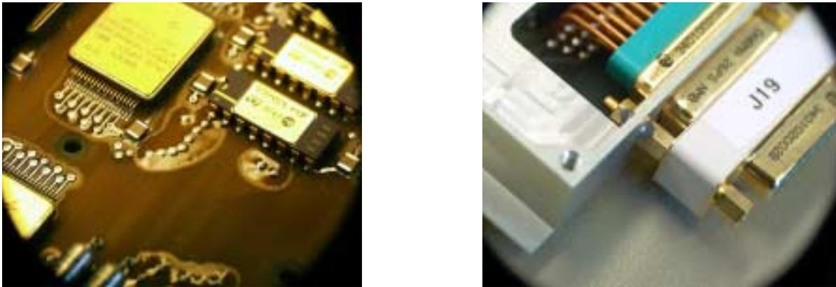
**Abbildung 3.1:** **Links:** Auf der Platine der HEPI sieht man den transparenten Kunstharz mit dem die Pins der elektronischen Bauteile fixiert werden. **Rechts:** Gut zu erkennen sind in dieser Makro-Aufnahme die zusätzliche Verklebung aller Schrauben mit einer grauen Kunstharz Masse. Mit „J19“ ist ein sog. *connection saver* gekennzeichnet. Er schützt die Kontakte der Schnittstelle vor Abnutzung während der letzten Tests.
