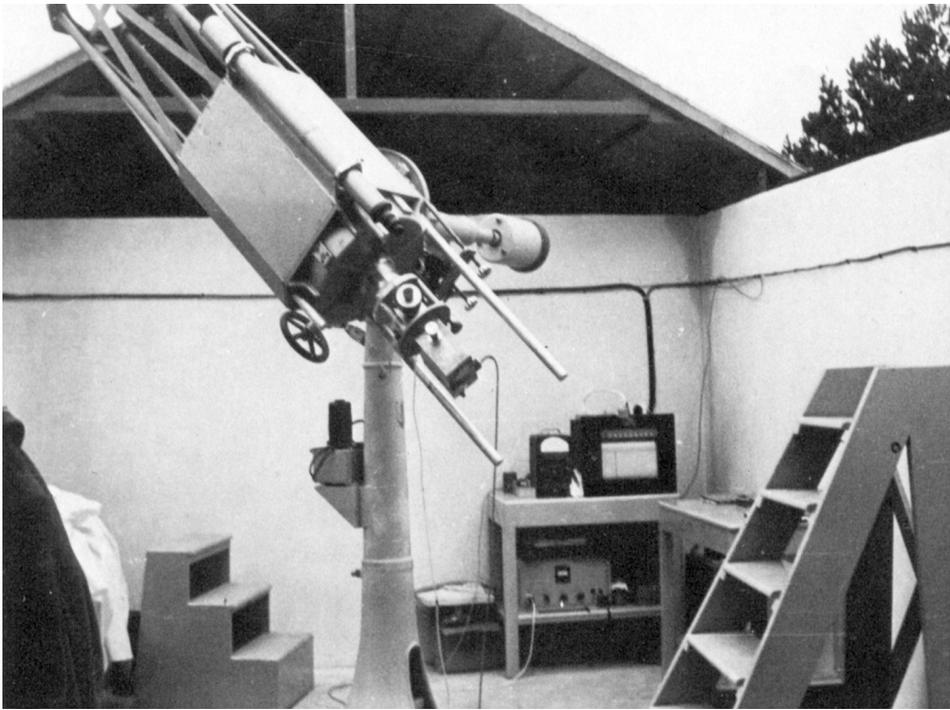
*Das zu Helligkeitsmessungen verwendete 40-cm-Spiegelteleskop des Tübinger Astronomischen Instituts während seiner Stationierung auf dem Ätna.*
