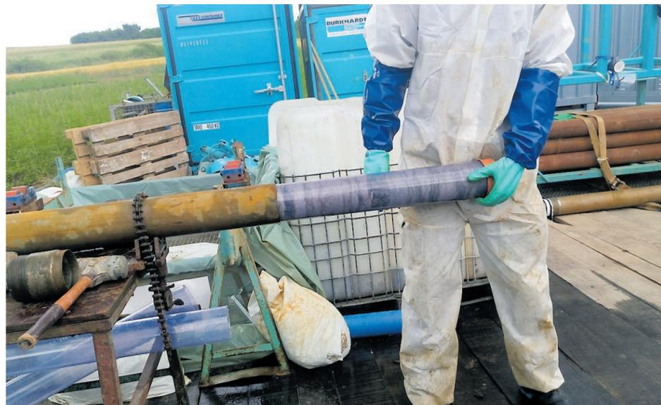
Um das aus der Tiefe gewonnene Material nicht zu verunreinigen, wurde es bereits beim Bohren mit einer Kunststoffhülle ummantelt.
