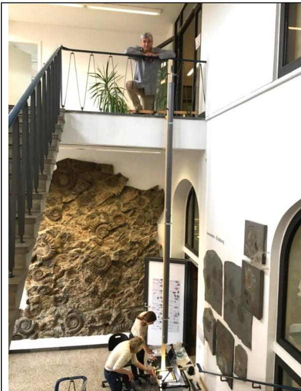
Versuchsaufbau für die Fallhöhe der Wassertropfen von 430 Zentimetern im Treppenhaus in der Paläontologischen Sammlung in der Tübinger Sigwartstraße 10. Am oberen Ende des Rohres wurden die Wassertropfen auf die Reise geschickt, unten bei den Schwimmpflanzenblättern ist die Hochgeschwindigkeitskamera aufgebaut.
