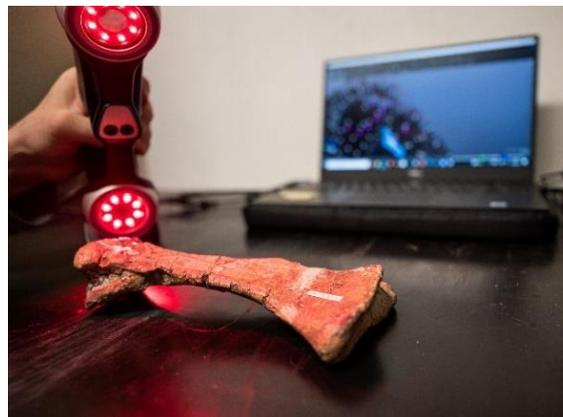
5. 3D-Aufnahme eines Fußknochens von *Tuebingosaurus* mit einem Handlaser-scanner. Die farbige Unterlage mit Reflektor-Punkten (links) dient der Software als räumliches Referenzsystem.
