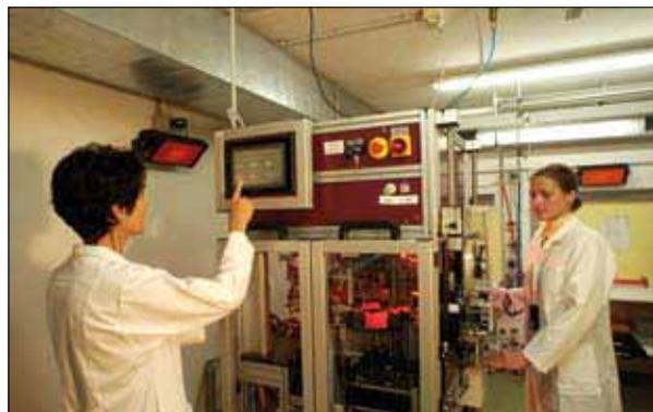
**Eine Auspackmaschine holt in der Dunkelkammer die belichteten Messfilme aus ihren Hüllen. Auf ein Band aufgebracht werden die Messfilme anschließend der Entwicklungsmaschine zugeführt.**
