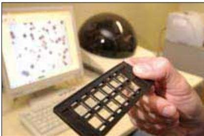
**Auswertegerät für Kernspurdetektoren: Die Anzahl der Spuren ist ein Maß für die Radonexposition.**
