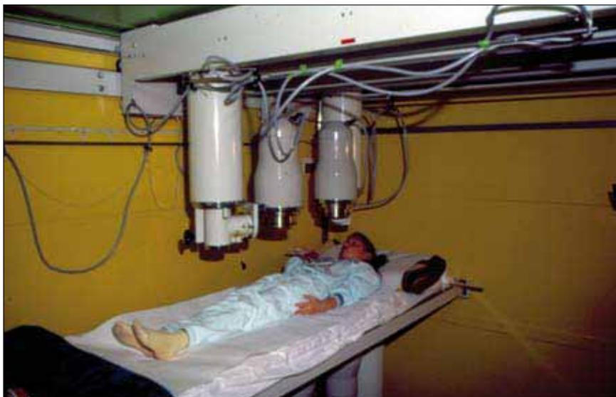
**Untersuchung im Ganzkörperzähler: Geschickte Anordnung von Detektoren ermöglicht es, die Aktivität von in den Körper aufgenommenen radioaktiven Stoffen zu bestimmen.**
