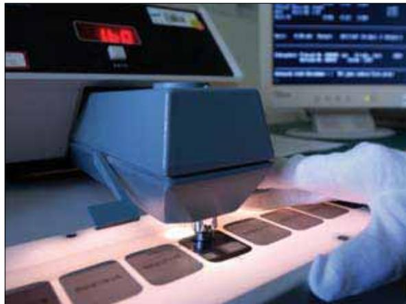
**Ein hochauflösendes Densitometer bestimmt die Grauwerte der auf dem Dosismessfilm befindlichen Felder. Mit Hilfe eines Kalibrierverfahrens kann aus diesen Informationen die Personendosis errechnet werden.**
