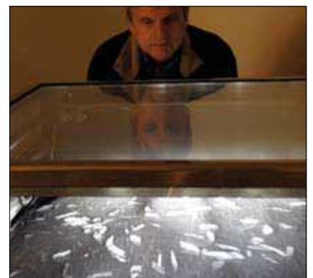
Der Strahlung auf der Spur: In der Nebelkammer können energiereiche  $\alpha$ - und  $\beta$ -Teilchen anhand der Kondensation eines übersättigten Ethanol-Wasserdampfes indirekt sichtbar gemacht werden.
