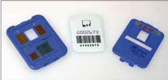
**Filmplakette für die Personendosimetrie: Ein lichtdicht verpackter Film wird durch auftreffende ionisierende Strahlung belichtet. Die Schwärzung ist ein Maß für die erhaltene Strahlenexposition.**
