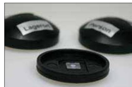
Passives Radonmessgerät mit Kernspurdetektor.
