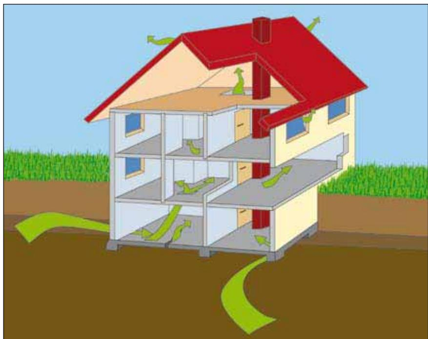
**Der Untergrund ist die Hauptquelle erhöhter Radonkonzentrationen in Häusern. Das radioaktive Edelgas Radon-222 kann durch Risse und Fugen, Abwasser- und Entlüftungsrohre, Rohr- und Kabeldurchführungen aus dem Erdbo-den in Gebäude übertreten, sich dort anreichern und zu einem erhöhten Lungenkrebsrisiko der Bewohner führen.**
