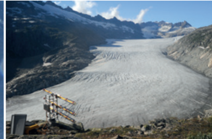
→ MIT SPEZIALGERÄTEN WIRD DIE FLIESSGESCHWINDIGKEIT DES SCHWEIZER ALETSCHEGLIETSCHERS VERMESSEN → THE FLOW VELOCITY OF THE GREAT ALETSCHE GLACIER IN SWITZERLAND IS MEASURED USING SPECIAL EQUIPMENT
