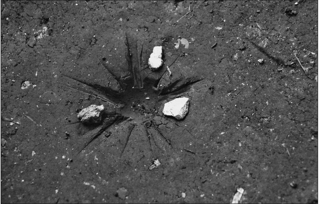
**Abb. 2:** Konkav verdichteter Untergrund mit zentralem Auffangloch und drei Steinen als Abstandhalter. Durchmesser des Loches: ca. 5 cm.
