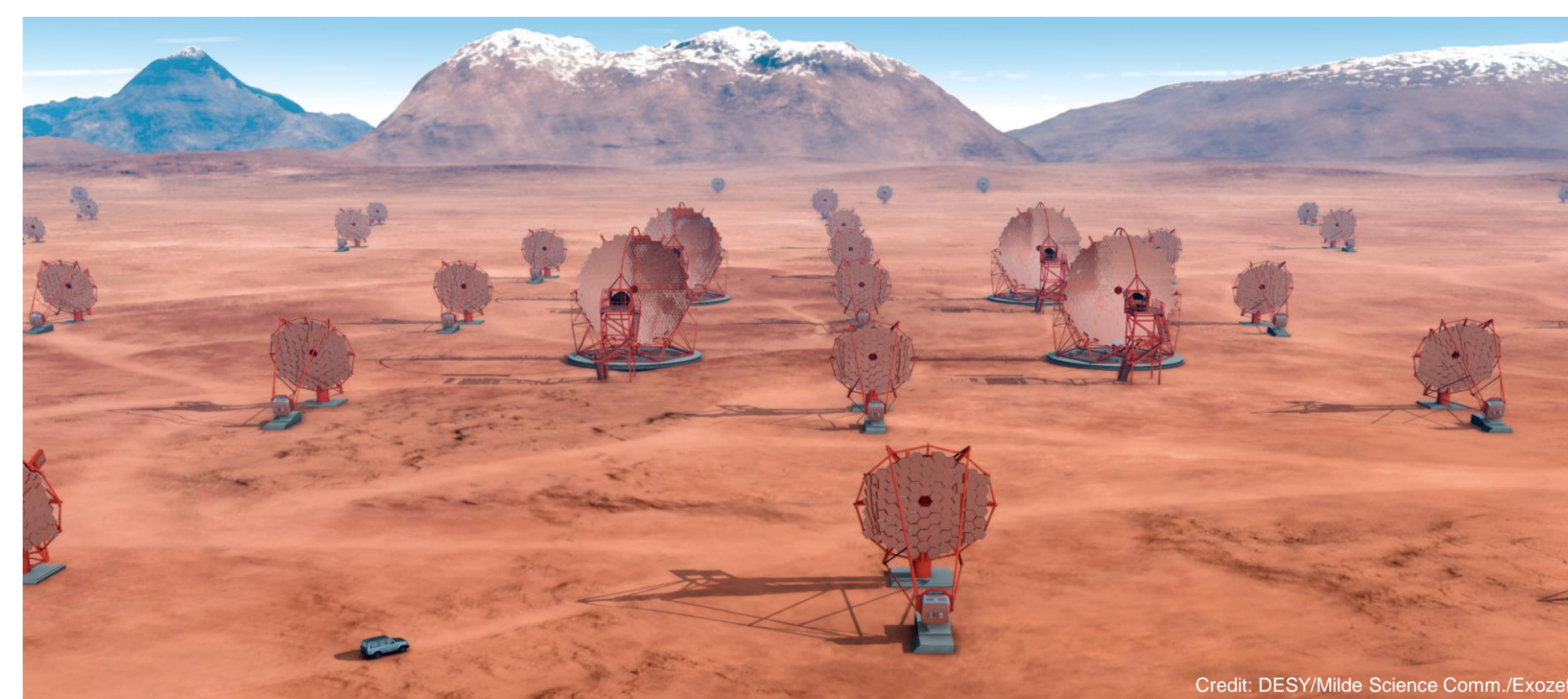
Abb. 5: Am CTA-Standort in Chile werden etwa 100 Teleskope auf einer Fläche von 4 km 2 errichtet. Um vier LSTs, die den niederenergetischen Bereich abdecken, gruppieren sich 30 MSTs. 70 SSTs sind weit verteilt, um die selteneren höchstenergetischen Gammaphotonen zu detektieren.
