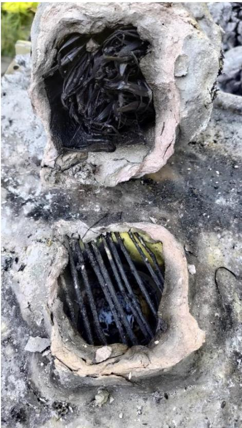
Eine zweite Möglichkeit zur Herstellung von Teer aus Steineiben ist die trockene Destillation der Blätter mit einer solchen unterirdischen Destillationsapparatur, die hier nach dem Experiment geöffnet wurde. Foto: Tabea Koch
