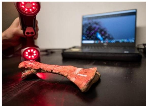
5. Imagen 3D de un hueso del pie de *Tuebingosaurus* que se está haciendo con un escáner láser de mano. La base de color con puntos reflectantes (izquierda) proporciona un sistema de referencia espacial para el software. Foto: Valentin Marquardt/Universidad de Tubinga
