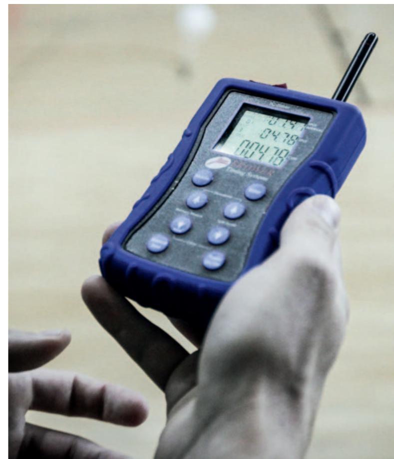
Mit Hilfe von Infrarot-Lichtschranken werden die gemessenen Zeiten auf das Messgerät übertragen.
