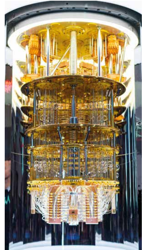
Innerer Aufbau des Quantencomputers IBM Quantum System One
