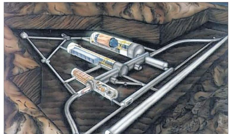
Inmitten des Gran-Sasso-Massivs befinden sich die Laboratori Nazionali del Gran Sasso (LNGS). Die drei Tunnelröhren bieten ideale Bedingungen für Teilchenforscher: Rund tausend Meter Gestein schirmen kosmische Strahlung weitgehend ab. Zu erreichen sind die Labore über einen Autobahntunnel.
