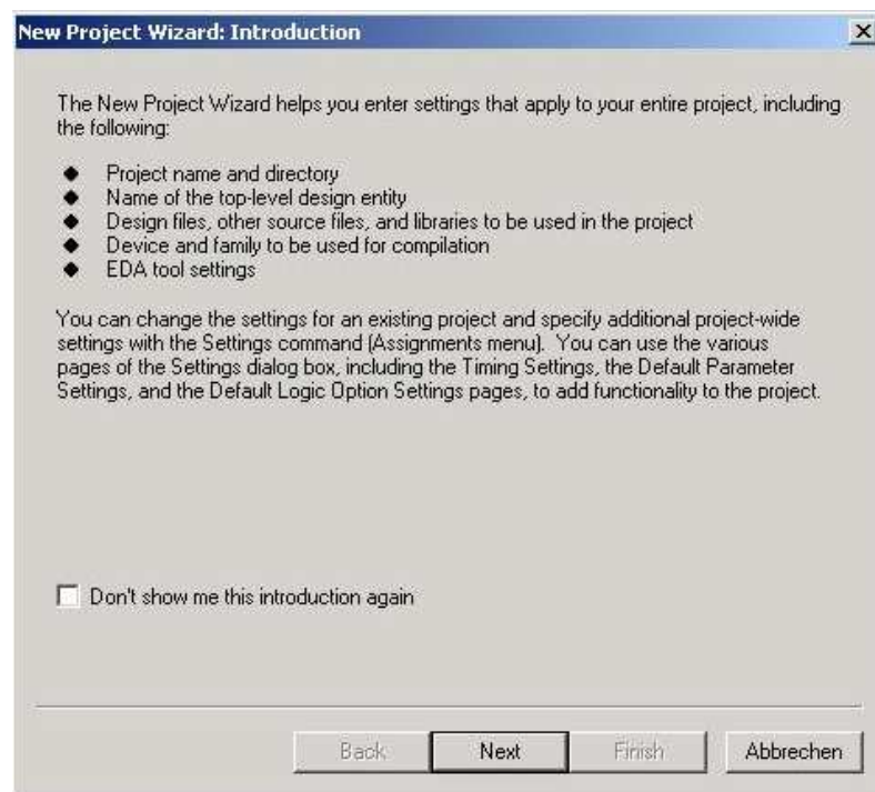
Abbildung 4.4: Über die GUI des New-Project-Wizard werden alle projektrelevanten Informationen zusammengestellt. Diese sind: Projektname, die beteiligten Source-Dateien, Altera Chip Familie und Chip-Typ. Siehe auch die folgenden Abbildungen 4.5 bis 4.8.
