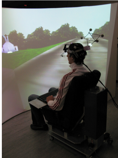
Abbildung 10: Der Proband, ausgerüstet mit Eye- und Headtracker auf dem Kopf, sitzt vor der Projektionsleinwand, auf welche die virtuelle Umgebung projiziert wird.
