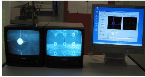
Abbildung 15: Foto des verwendeten Equipments: Die beiden linken Monitore zeigen die Bilder von Augen- und Szenenkamera. Auf dem rechten Monitor sieht man die Eyetracker-Software.
