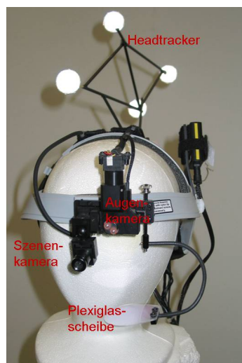
Abbildung 14: Head- und Eyetracker werden mit Hilfe eines verstellbaren Bandes am Kopf des Probanden fixiert.
