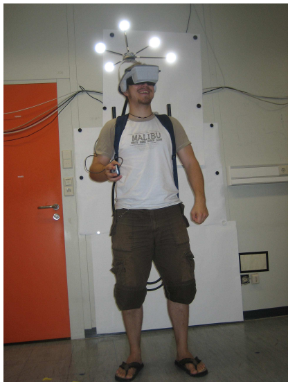
(a) Eine Versuchsperson von vorne. Zu sehen ist das HMD mit den Reflektorkugeln. Die Kugeln reflektieren hier das Blitzlicht.
