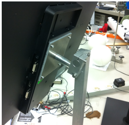
Abb. 5: Monitorhalter aus Aluminiumprofilen; mittig ist das Gelenk mit zwei Freiheitsgraden, zur Einstellung der Neigung und Rotation des Monitors zu sehen. Dieser ist über die VESA Wandhalterungsverschraubung mit dem Monitorhalter verbunden.
