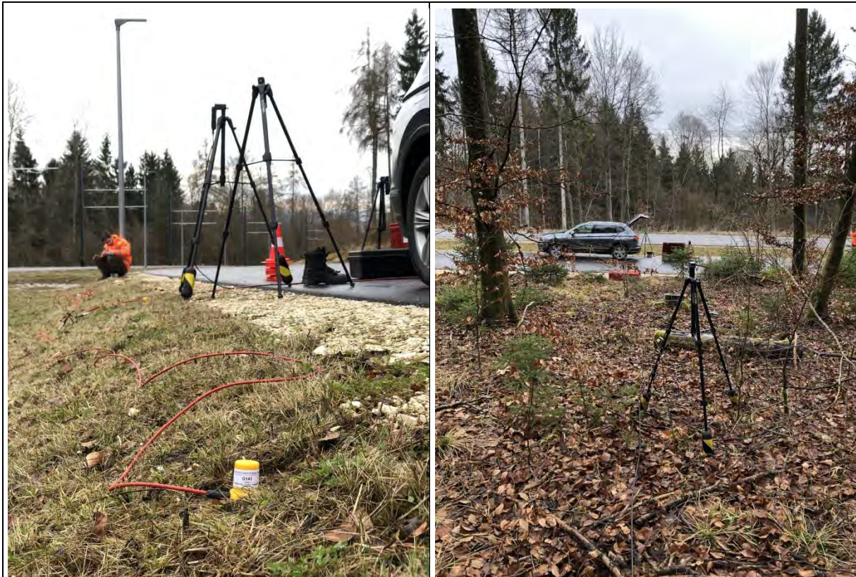
MP3 und EMI1 im Abstand von 10m vom Gleis
