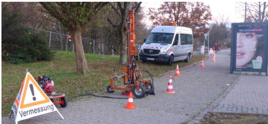
Abbildung 3-2: Künstliche Impulsanregung DYNPACT®
