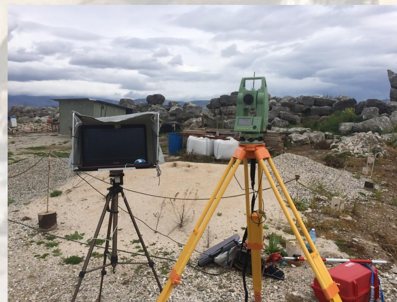
Totalstation + Computer zur Vermessung der Unterburgmauer (eigene Aufnahme).
