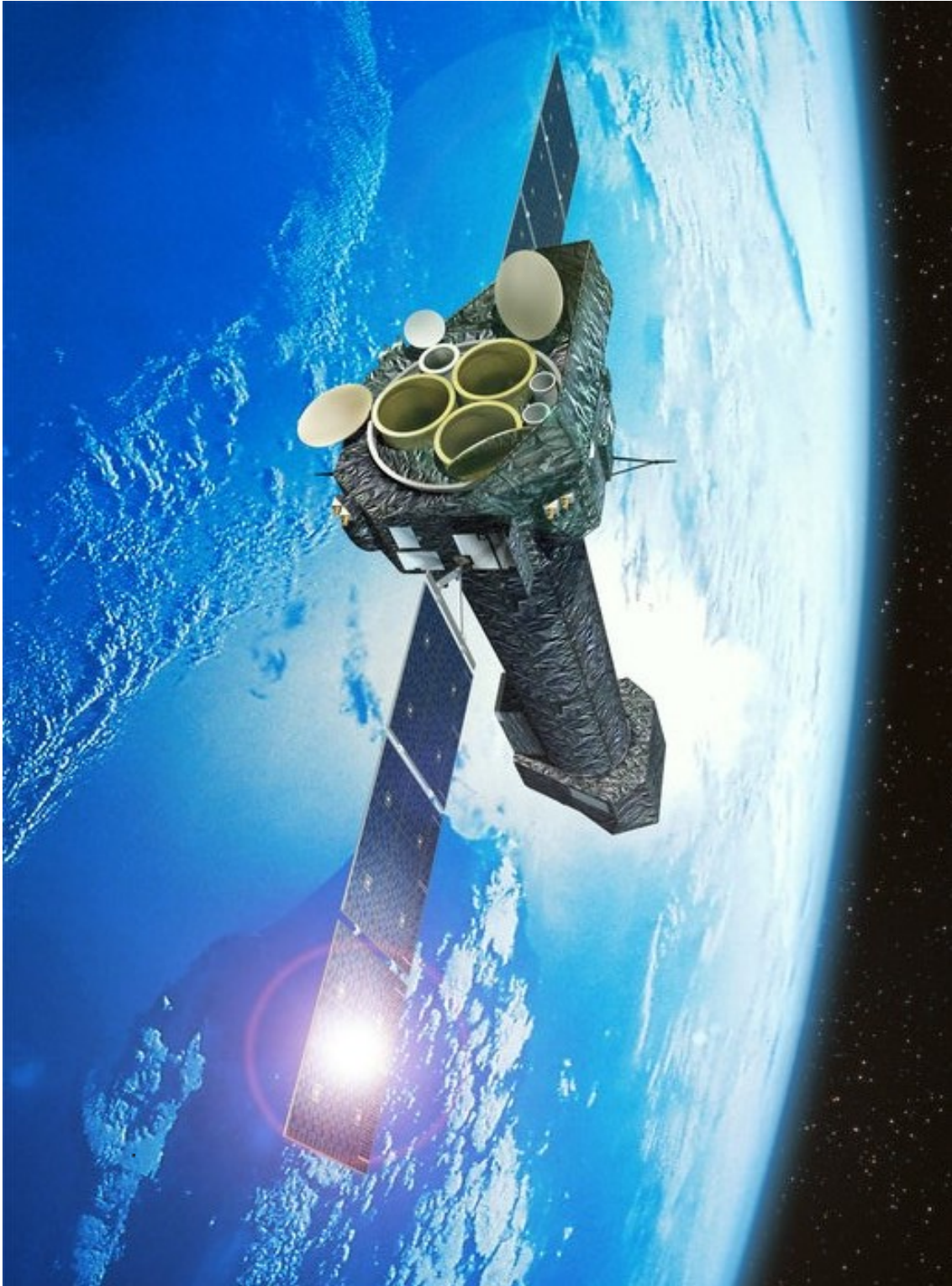
Abbildung 1.11: Künstlerische Darstellung von XMM-Newton im Erdorbit. Gut erkennbar sind die drei Öffnungen für die Wolteroptiken auf der Oberfläche des Teleskops. Am hinteren Ende befinden sich die drei EPIC-Instrumente und die RGS-Spektrometer
