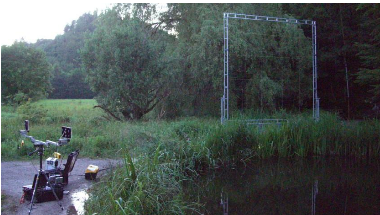
Versuchsaufbau zur Messung der Ortungslaute von Fledermäusen. Foto: Jens C. Koblitz/Universität Tübingen
