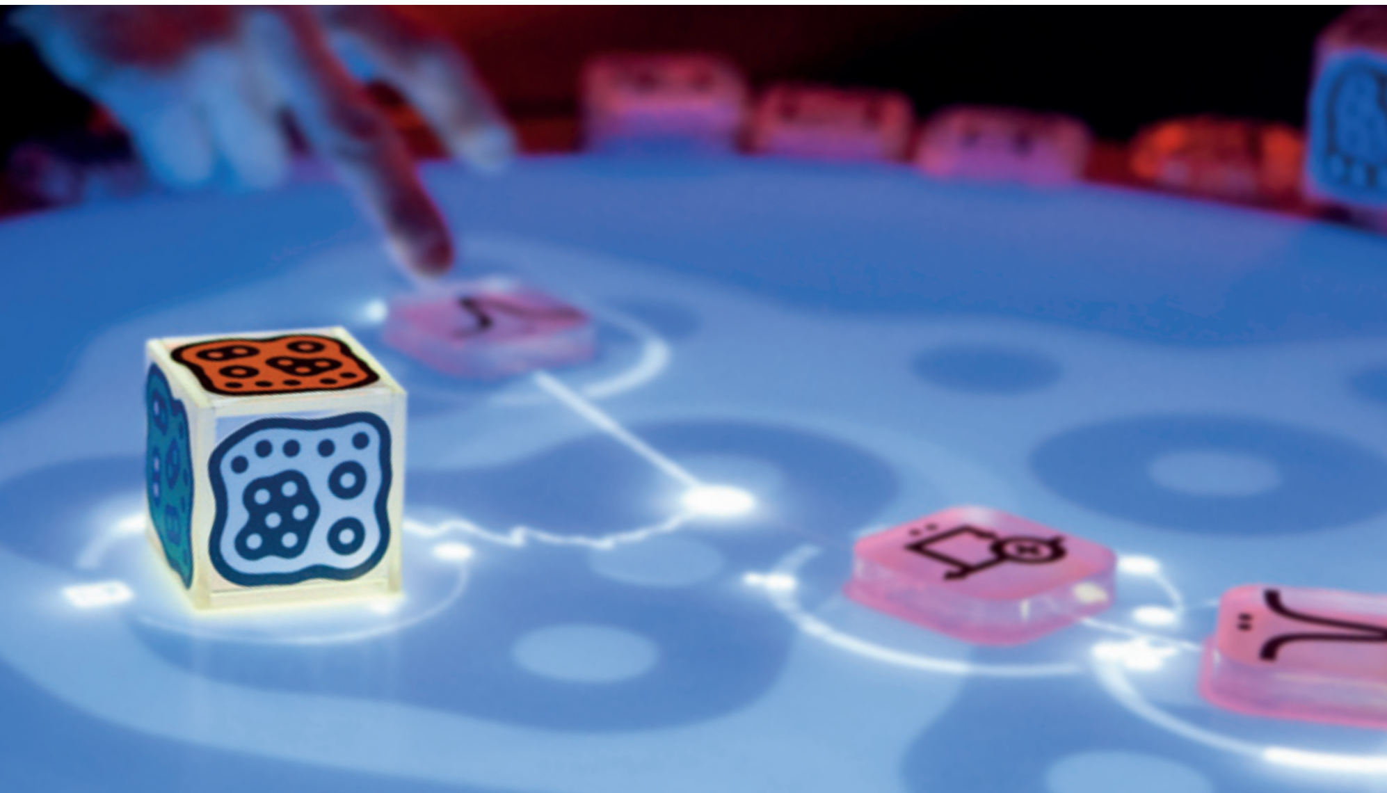
→ DER REACTABLE: AUF EINEM TOUCHSCREEN ERZEUGT DER DJ SOUNDEFFEKTE DURCH DAS BEWEGEN VON „WÜRFELN“ → THE REACTABLE: THE DJ CREATES SOUND EFFECTS ON A TOUCH SCREEN BY MOVING "DICE" AROUND
