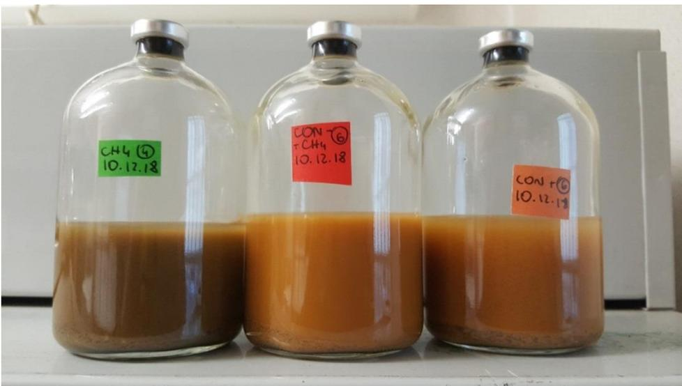
Inkubationsexperiment mit Sedimenten aus dem vietnamesischen Van Phuc: Bei Zusatz von Methan zum Sediment setzen Bakterien das enthaltene Eisen um. Dabei wird Arsen freigesetzt, erkennbar an der Farbe des Sediments, die von orange in ein dunkles Braun wechselt (von rechts nach links). Foto: Andreas Kappler
