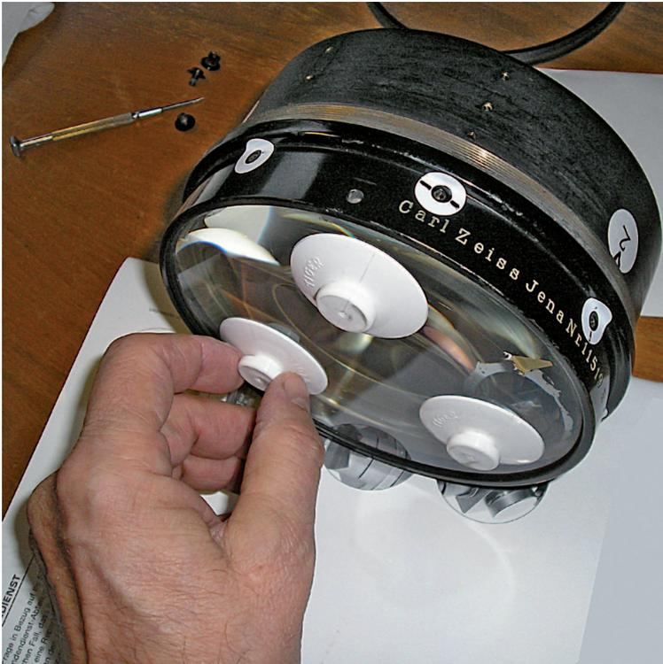
Bild 10: Entnehmen der ersten Linse des B130
