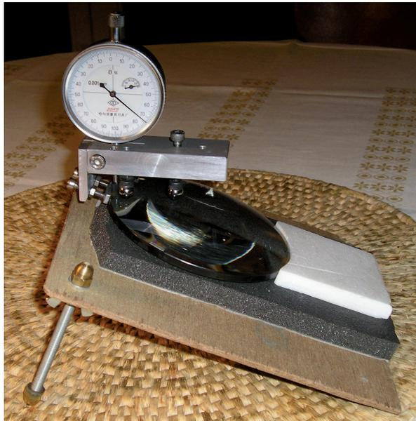
Bild 13: Messaufbau zur Kontrolle der Distanzplättchen
