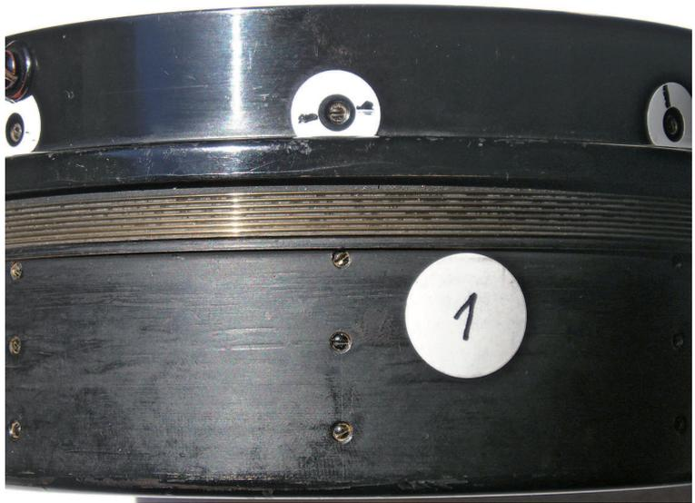
Bild 7: B 110, Fassung wie bei Fraunhoferobjektiven üblich.
