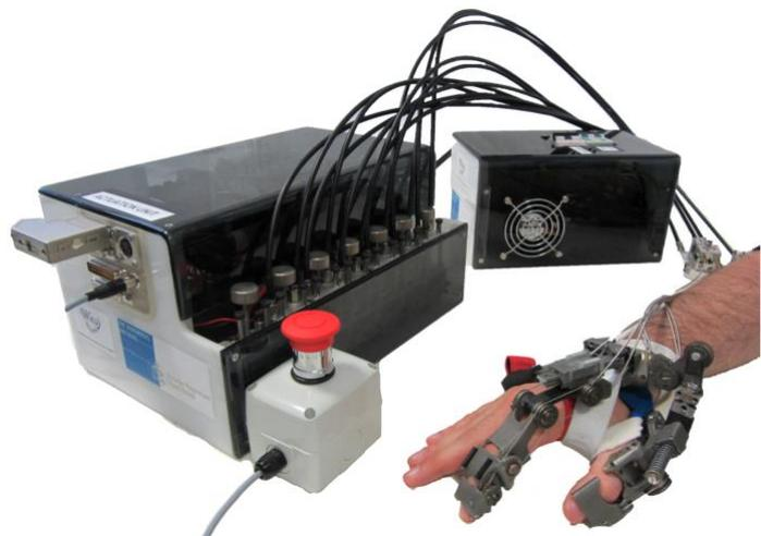
Das hirngesteuerte Hand-Exoskelett ermöglicht Querschnittsgelähmten, ihre Hand wieder zu benutzen.
