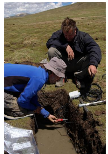
Installation einer Bodenmonitoringstation in einem Bodenprofil.
