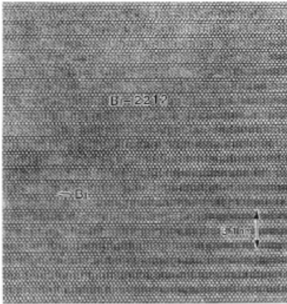
Abbildung 1.6: Transmissions-Elektronenmikroskopie am Hochtemperatursupraleiter \text{Bi}_2\text{Sr}_2\text{CaCu}_2\text{O}_8 (abgekürzt: Bi-2212). (O. Eibl, Institut für Angewandte Physik)
