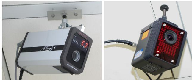
**Abbildung 3.2.:** Infrarotkameras. Links: eine der vier Kameras, die in den Ecken des Raumes angebracht sind. Sie sind in Abbildung 3.1 mit K1-4 gekennzeichnet. Rechts: eine der beiden Kameras, die in der Mitte des Raumes hängen (Abbildung 3.1 K5+6).
