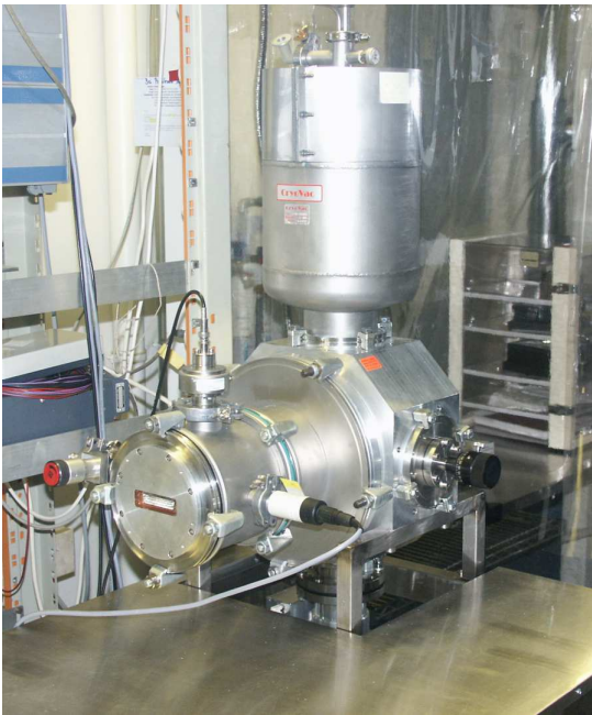
Abbildung 6.2: Die Vakuumkammer mit aufgesetztem Kryostaten zur Kühlung des CCDs.
