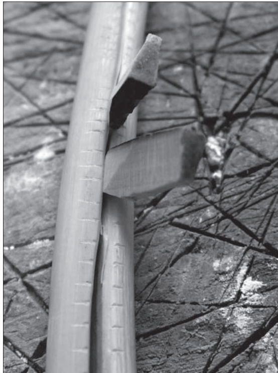
Abb. 15: Die Verlängerung des Spalts, indem ein Keil vor den anderen gesetzt wird. Foto: R. Ehmann.
