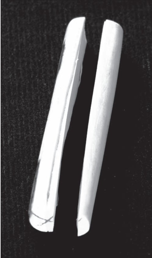
Abb. 12: Elfenbeinstab mit Sollbruchstelle und ausgelaufenem Spalt. Foto: R. Ehmann.
