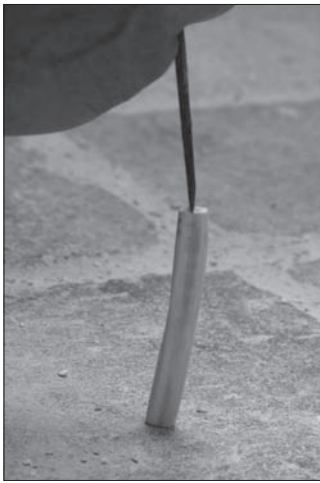
Abb. 9: Eintreiben eines Spalts von oben mit einem Stechbeitel. Foto: M. Malina.
