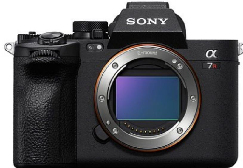
*Der rückwärtig belichtete Kleinbildsensor der Sony Alpha 7R V löst hohe 61 Megapixel auf und ist zur Bildstabilisierung beweglich gelagert. Bis zu acht Blendenstufen längere Belichtungszeiten sollen damit möglich sein.
