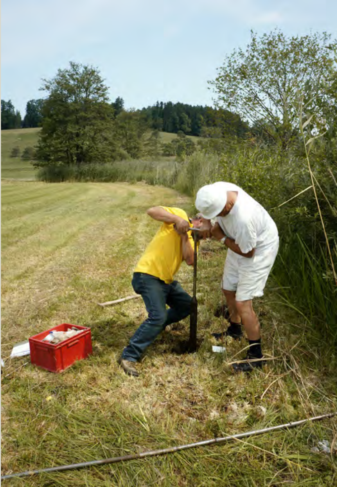
Abb. 1 Handbohrung in Feuchtsedimenten.
