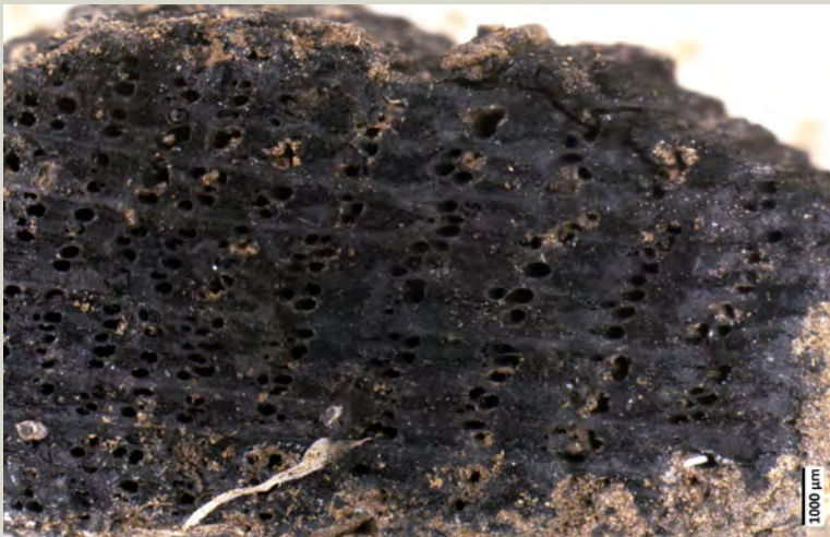
Abb. 5 Querschnitt einer Eichen-Holzkohle der Fundstelle Pfäffingen-Lüsse (LUE02_037) bei 10facher Vergrößerung. Erkennbar sind die großen Frühholzgefäße und die breiten Holzstrahlen. Von rechts nach links (Wuchsrichtung) sind 12 Jahrringe erkennbar. Die Jahrringe sind zwischen 1,5 und 0,5 mm breit.
