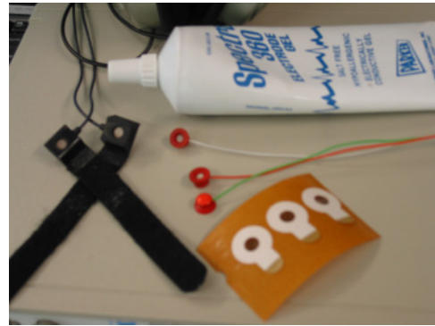
Abbildung 21: Utensilien zur physiologischen Emotionsmessung: GSR-Transducer, Elektroden, Kleberinge und Elektrodengel.
