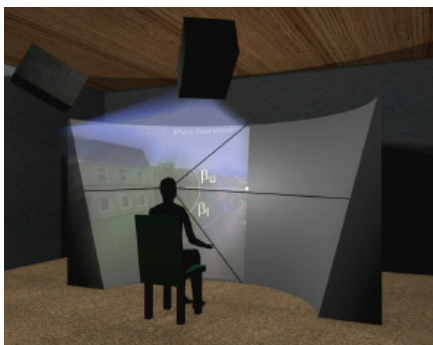
Abbildung 13: Simulierte Darstellung des Versuchsaufbaus, wobei nur auf eine Hälfte der Leinwand projiziert wird. \beta_{\text{D}}=25^\circ , \beta_{\text{H}}=45^\circ
