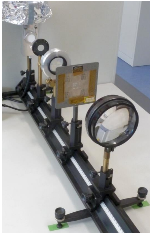
Abb. 3.2 Die optische Bank mit allen Komponenten (von hinten nach vorn): Lampe, kleine Irisblende, Linse mit großer Irisblende, Testmaske, Kondensator.
