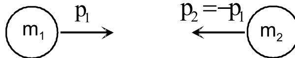
Abbildung 3.15: Eindimensionaler elastischer Stoß zwischen zwei Massenpunkten, die mit entgegengesetzten Impulsen aufeinander zufliegen.
