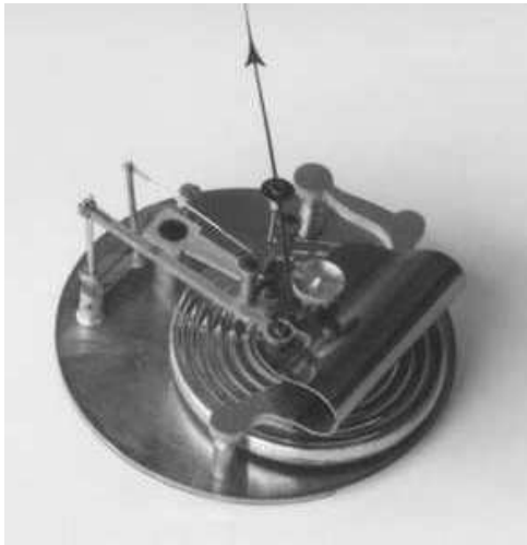
Abbildung 6.19: Aneroidbarometer ("Vidiedose") nach Lucien Vidie (1805-1866). Quelle: http://www.freunde-alter-wetterinstrumente.de/12barges.htm
