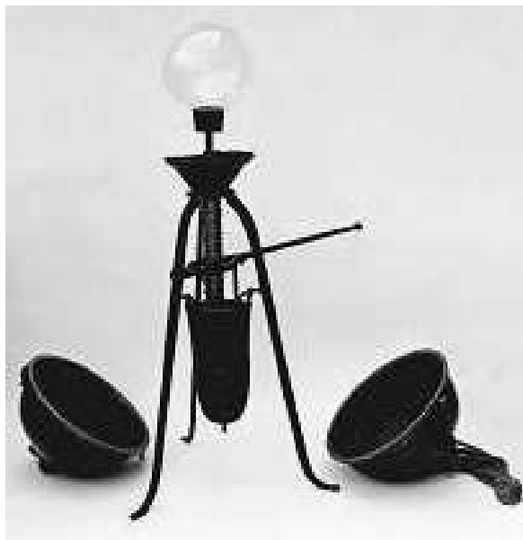
Abbildung 6.13: Magdeburger Halbkugeln (Original) . Quelle: http://www.deutsches-museum.de/ausstell/dauer/physik/physik1.htm
